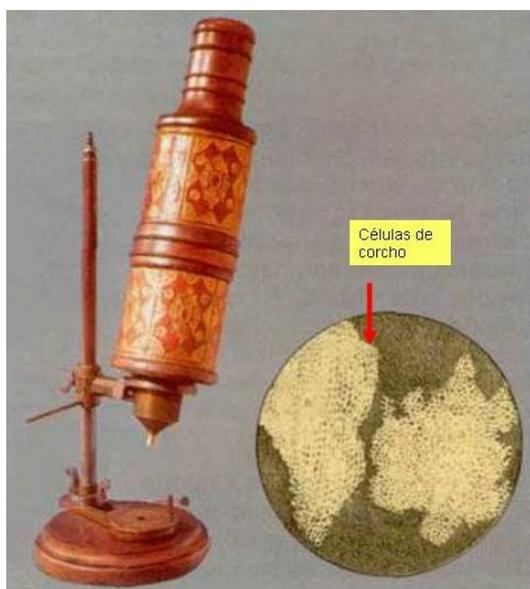
Microscopio de Robert Hooke y esquema de las células de corcho realizado por él.
